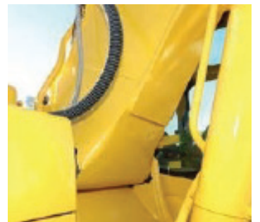
Döküm bom şasi bağlantısı ve tek sactan oluşan dayanıklı bom yapısı
