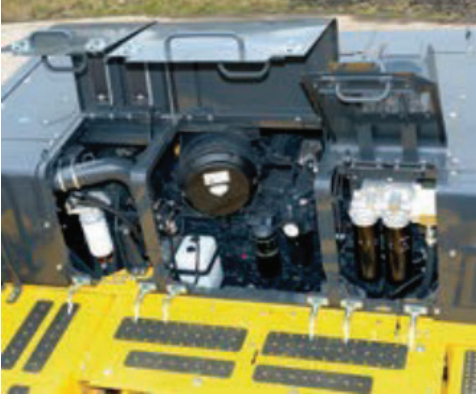
Motor kaputunun ön tarafındaki filtrelere kolay erişim
