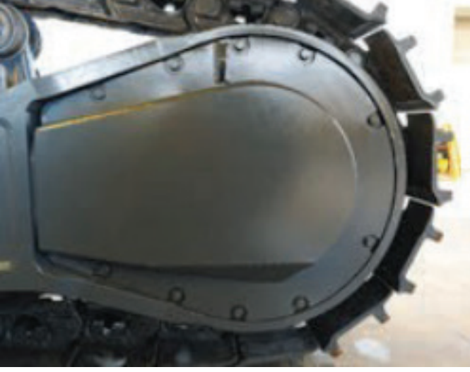
Sağlam yürüyüş motoru korumaları
