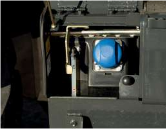
Zemin seviyesinden AdBlue®, yakıt ve hidrolik yağ dolumu
